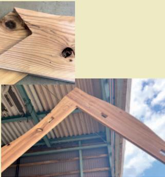
ました。木材同士の噛み合わせがある接合部のため、データの微調整や切削工程を細かく検討する必要があります。なりすがたです。まだまだ調整が必要な部分があります。が、これまでに最大のもの製作となるのでワクワクしています！
